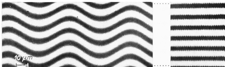
Abb. 3. Interferenzmikroskopische Aufnahmen von mit 1 MHz beschallten Bruchflächen. (Interferenzschritt \Delta = 0,3 \text{ μm} .) Vergr. = 600 \times .
